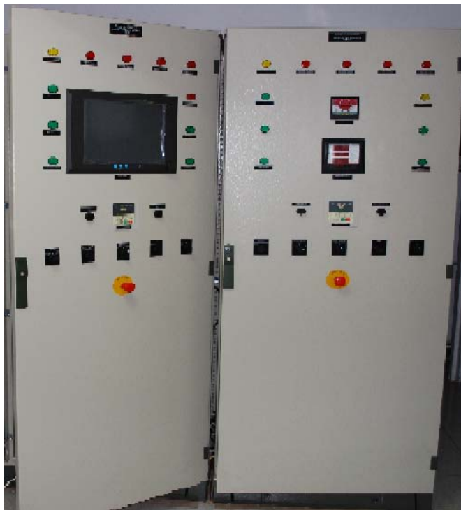
Fig. 4. . Instalația de Automatizare Grup Motor de curent continuu – Generator Sincron
