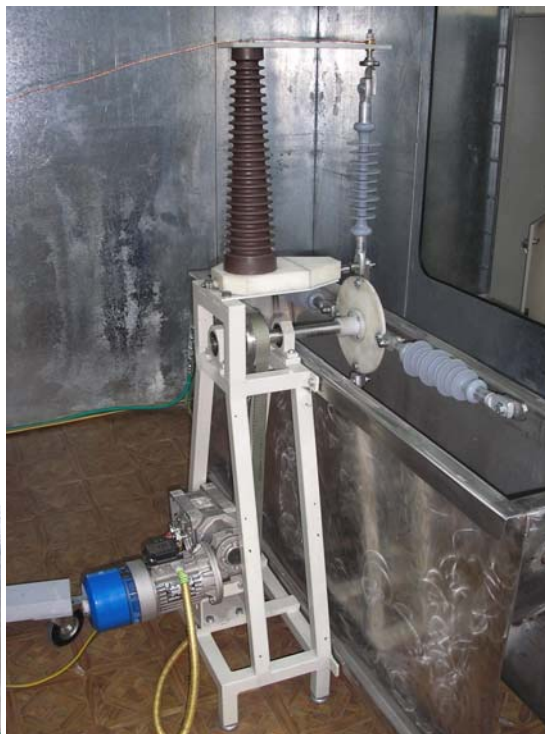
Fig.5. Ansamblu suport mecanism rotire izolatoari
