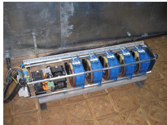
Fig.2. Autotransformator reglabil ESS 230/230/110 MDC
