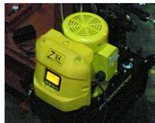
Sistem hidraulic pentru generarea și ajustarea forței
