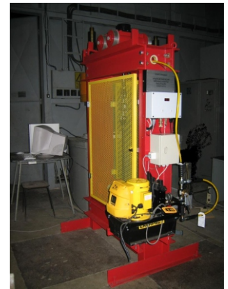
Cadru de forță 50 kN
